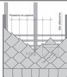
ственно на поверхности досок. Деревянные бруски должны быть сухими. Все деревянные детали должны быть пропитаны хим. составами, защищающими древесину от увлажнения и гнили.
