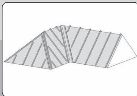
Схема устройства контробрешетки
