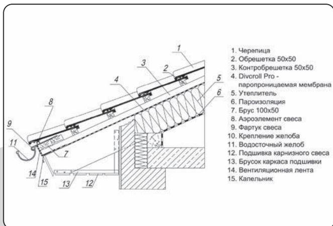
**Важно!** Выполняя подшивку карнизного свеса, обязательно обеспечьте приток воздуха под гидроизоляционную пленку:
